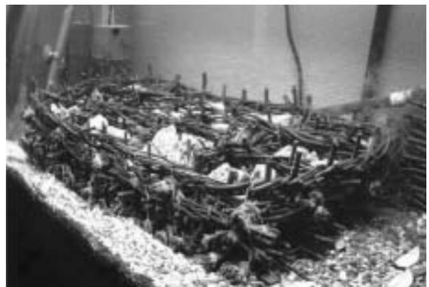
写真2 粗朶沈床の模型
