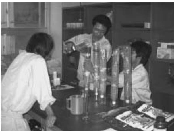
写真10 手作りのペットボトルろ過装置
