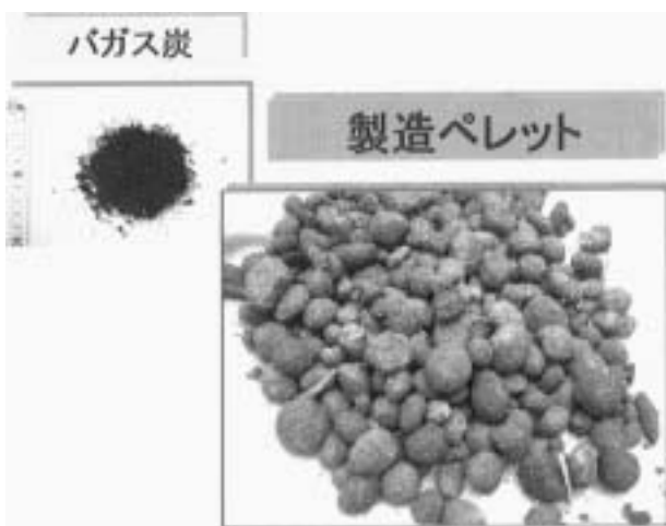
図7 改良ペレットBio-Pの形状
