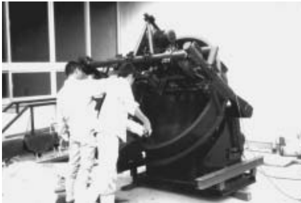
写真8 ペレット製造試験（バガス+バガス炭の添加）
