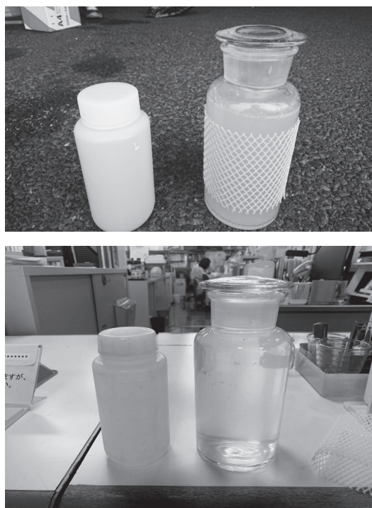
図5 上：油水分離装置設置前、下：油水分離装置設置後
