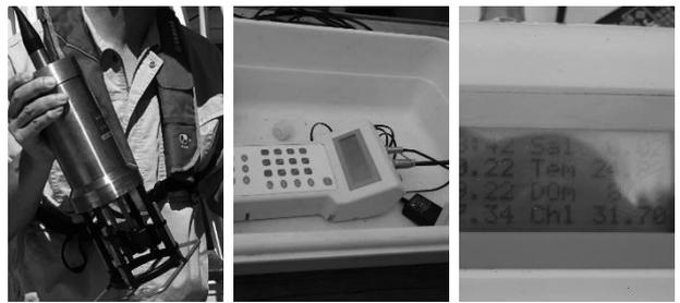
図5 水質調査の測定装置 CTD (多項目水質計)
