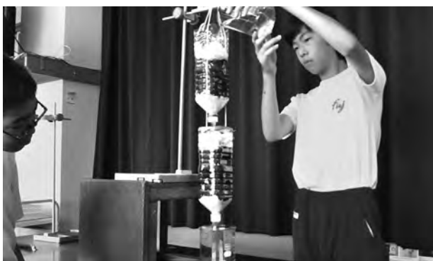
写真7 手作りのろ過器で雨水をろ過する様子
