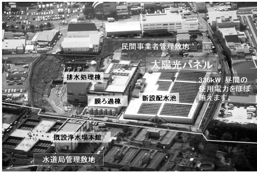
図5 太陽光発電設備の設置状況
