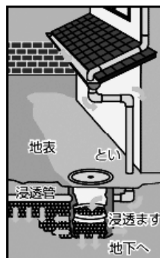
図-4 浸透枡の仕組み（出典：小金井市）
