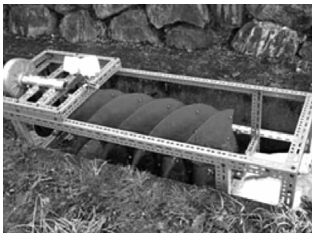
図1 螺旋水車：用水路での水車実験
