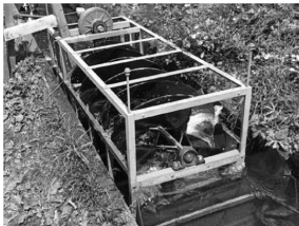
図2 螺旋水車：通信、電気柵用電源
