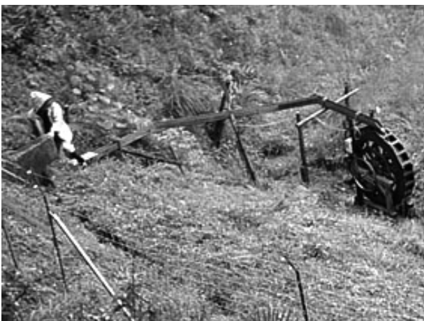
図4 木製水車：電気柵用電源
