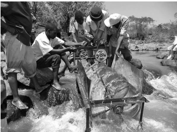
図17 タンザニアで動き始めた螺旋水車
