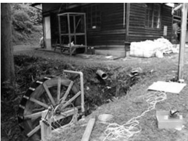
図5 木製水車：防災ハウス独立電源
