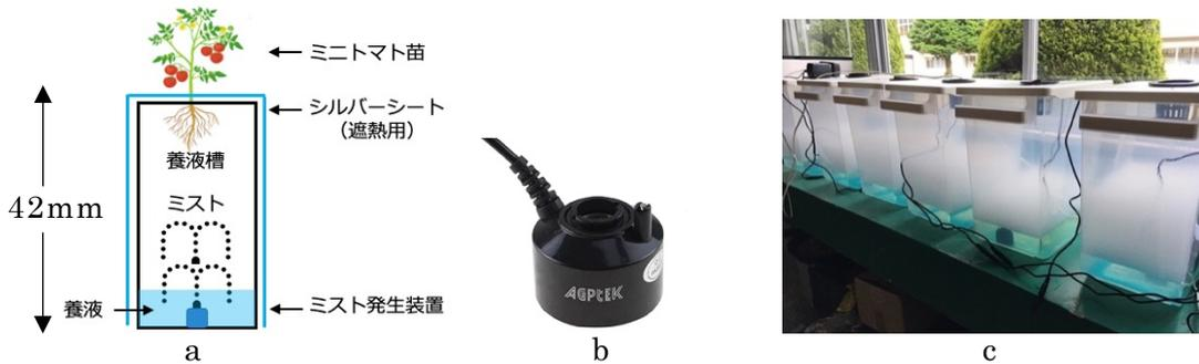
図5 自作栽培装置(a: システム図 b: ミスト発生装置 c: ミスト発生装置)
