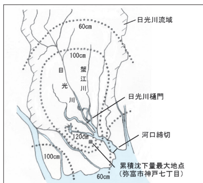
地盤の累積沈下量図 (『地盤沈下調査結果 愛知県』2011.8 より作成)
