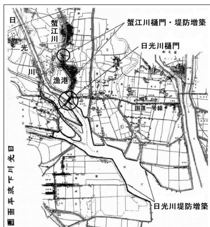
日光川樋門、蟹江川樋門および日光川堤防増築工事の位置(水谷 錦『愛知縣における河川の大観』(1931)掲載図に加筆)
