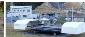
▲②UAVによる自動監視(給電やデータ伝送を含む)を可能とするドローンポート
