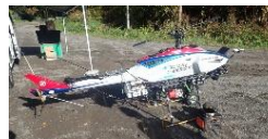
▲②衛星通信による長距離飛行可能な小型無人ヘリ
