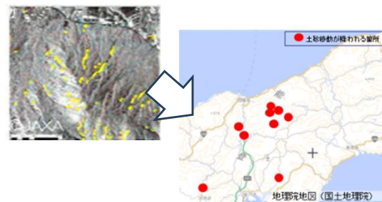
▲①AI等や画像解析技術を活用し、土砂移動箇所の抽出を自動化(イメージ)
