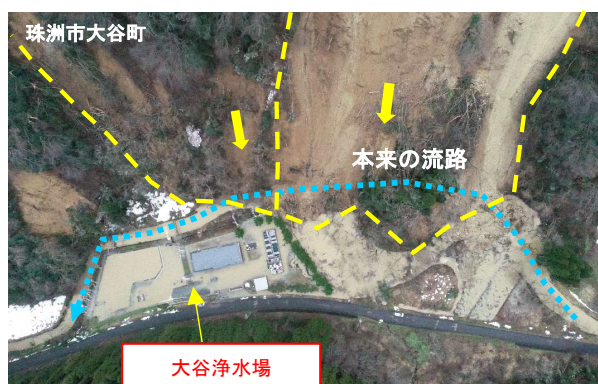
浄水場を機能停止にした河道閉塞
