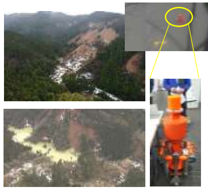
▲能登半島地震で発生した天然ダムと投下型水位計(R6能登半島地震)
