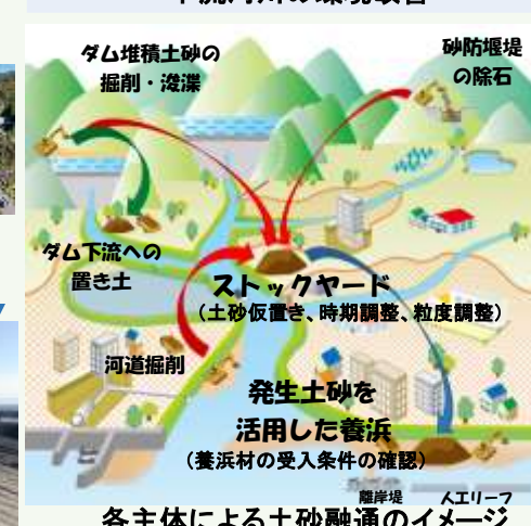
瀬淵分布の多様化、魚類の多様度が増加 土砂還元によるダム堆砂対策と 下流河川的环境改善
