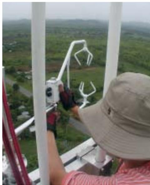
タイ・ターク市近傍に設置した120mのタワーにおける熱・水・二酸化炭素フラックス観測の様子
