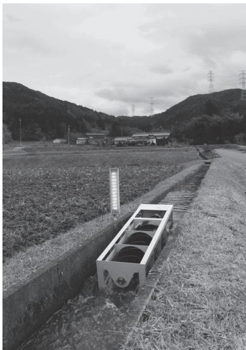
写真2 螺旋式ピコ水力発電装置「ピコピカ10」
