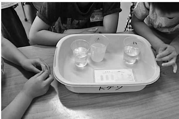
水の汚れを科学的にCOD 簡易パックテストで測定。
