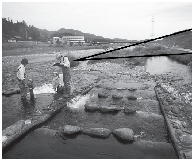
県とFWSによる魚道カルテを用いた魚道点検状況
