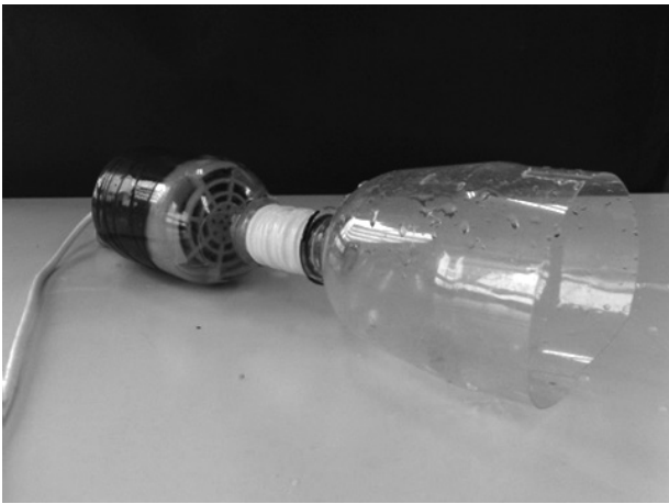
図Ⅲ-8 ゴミ回収槽
