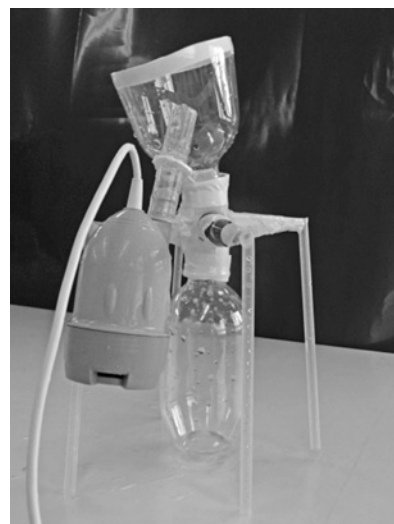
図VII-1 海底セシウム回収装置
