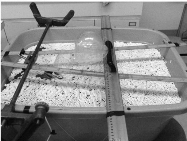
図Ⅲ-9 水噴流によるゴミ回収の実験
