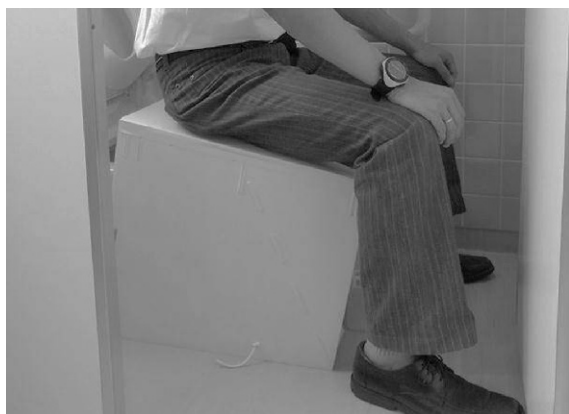
写真2 洋式トイレに設置したプラスチック段ボール製ポータブル型し尿分離トイレユニット
