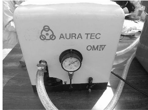
写真9 マイクロバブルの発生装置
