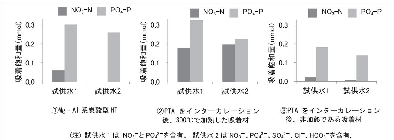
図7 Mg-Al系炭酸型HTとTiO<sub>2</sub>を組み込んだHTにおけるNO<sub>3</sub><sup>-</sup>とPO<sub>4</sub><sup>3-</sup>除去量の比較
