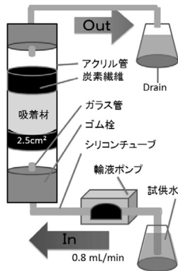
図6 NO<sub>3</sub><sup>-</sup>選択性検証用実験セット
