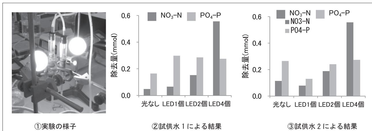
図9 Ni担持Mg-Al系HTの層間にTiO<sub>2</sub>を固定した吸着材とLED光を用いたNO<sub>3</sub><sup>-</sup>除去実験。
