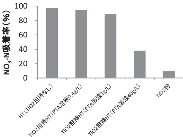
図5 HTにTiO<sub>2</sub>を担持した吸着材のNO<sub>3</sub><sup>-</sup>の吸着率の比較
