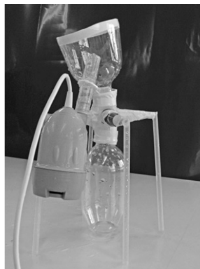
図VII-1 海底セシウム回収装置
