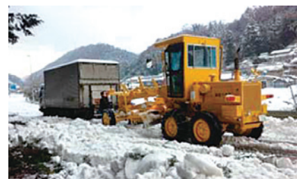
除雪車により車両を牽引 (四国地方整備局HP)
