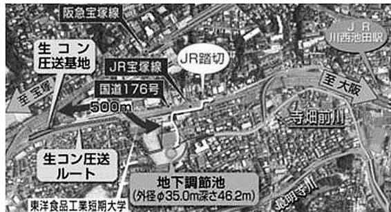
〈写真—2〉 寺畑前川調節池工事概要
