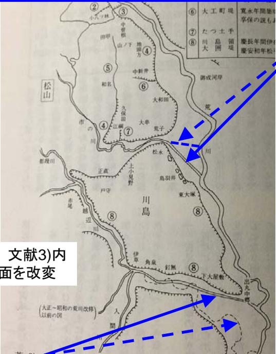
市野川と荒川の合流点は西遷後に下流に付け替え(1723)
