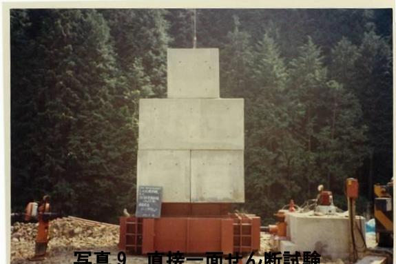
写真9 直接一面せん断試験
